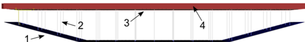
Obrázek 2: Pohled z vrchu na absorbér s označením jeho částí. Přední plech (1), prvky typu konektor představující kompozitové trubky (2), zadní plech (3) a výstužné struktury z ocelových profilů (4)
